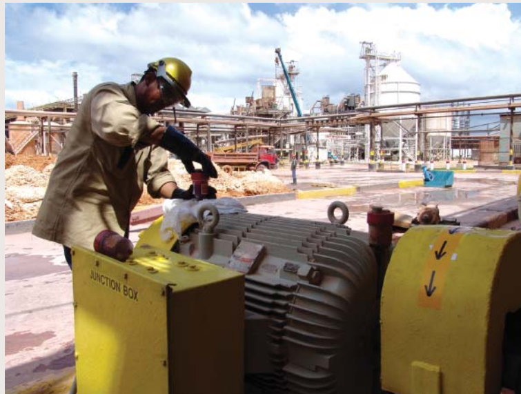
Guno Kromopawiro verwisselt de electro luber in het kader van Autonomous Maintenance.
