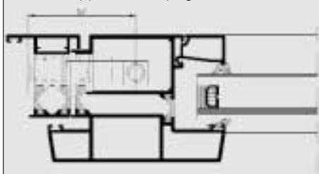
Verzwaarde deurvleugel (RT 52) met stolprofiel en espagnoletslot 272585.
