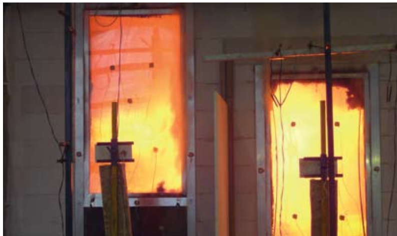
Testopstelling tijdens vuurtest. Links draaikiep raam met onderlicht, rechts draaikiep raam.
